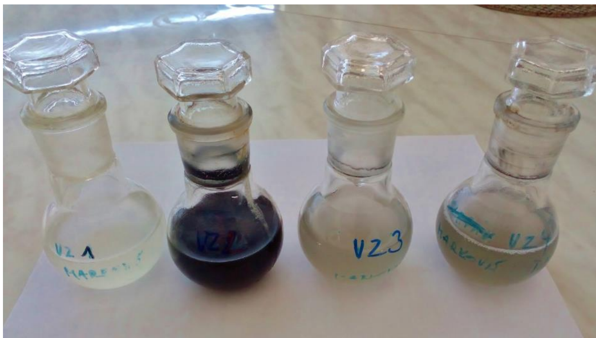
Obr. č. 3: Mikrobiální kultury schopné reduktivní dehalogenace chlorovaných ethenů izolované ze vzorků ze studny ST-3 v areálu bývalé čistírny „Na Vrtálně“ v Pardubicích. Pro identifikaci mikroorganismů a další experimenty sloužila kultura č. 1 ze vzorku podzemní vody a kultura č. 2 (baňka s černým obsahem) ze vzorku sedimentu, která vykazovala nejlepší vlastnosti
