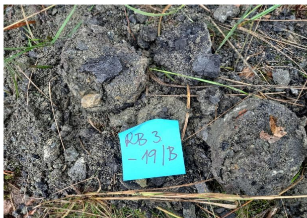
Foto 3: Detail vrtného jádra strojního závrtu RB3-19 na lokalitě 3 – hloubková úroveň 1 – 2 m
