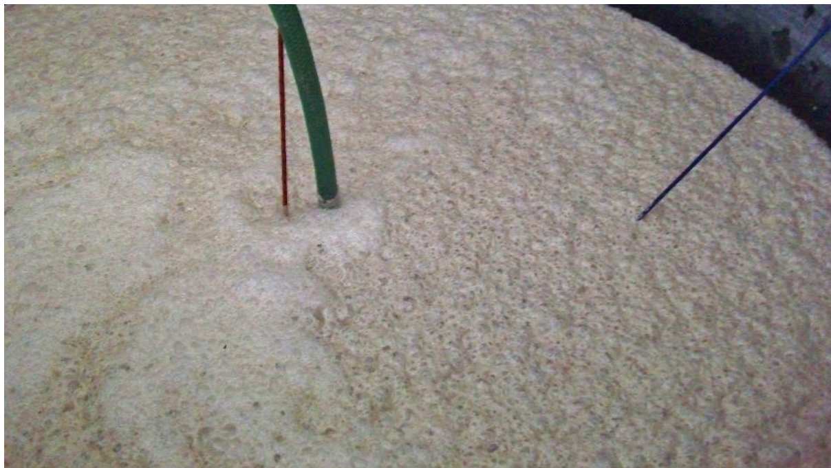
Obr. č. 2: Pohled do bioreaktoru při výrobě mikrobiální suspenze pro sanaci míst znečištěných ropnými uhlovodíky
