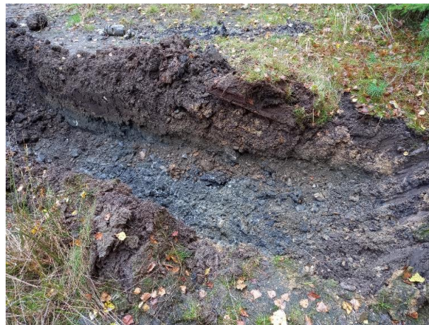
Foto 6: Detail kopané sondy na lokalitě 3 - asfaltové směsi
