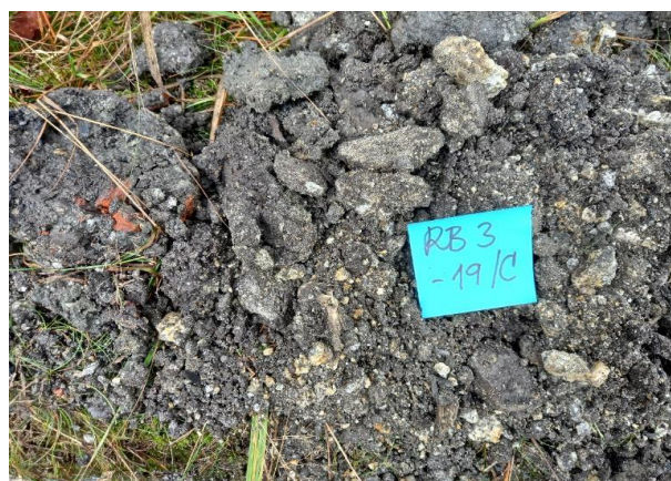
Foto 4: Detail vrtného jádra strojního závrtu RB3-19 na lokalitě 3 – hloubková úroveň 2 – 3 m
