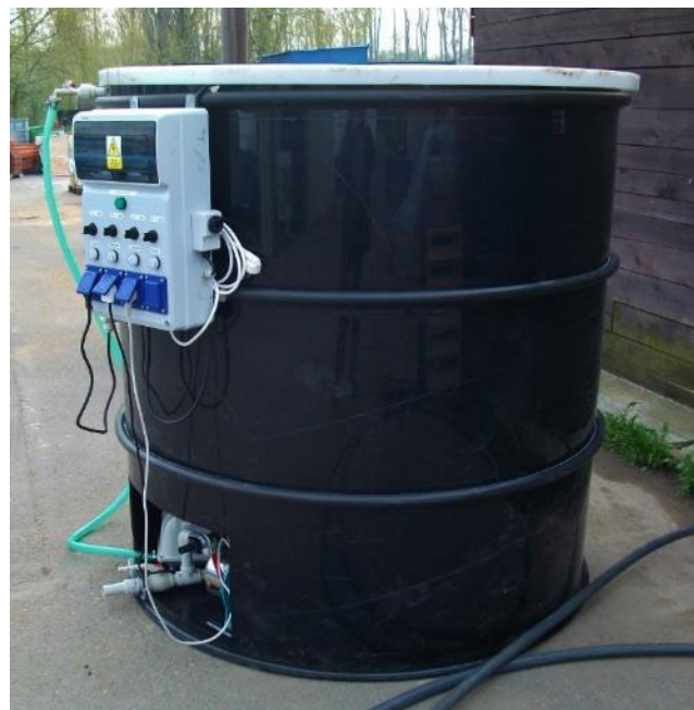
Obr. č. 1: Bioreaktor pro výrobu mikrobiální suspenze k bioaugmentaci horninového prostředí znečištěného ropnými uhlovodíky
