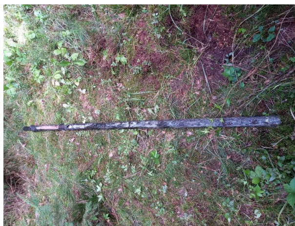
Foto 8: Detail ručního závrtu na lokalitě 7 -zemi-na s dehtem
